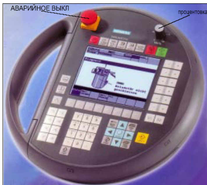
Рис. 5-15 Handheld Terminal HT 6 фронтальная сторона
