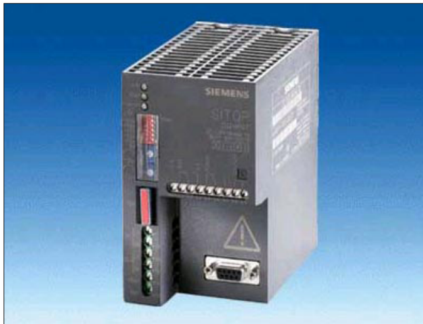
Рис. 2-27 Вид: SITOP POWER DC-UPS-MODULE 10
